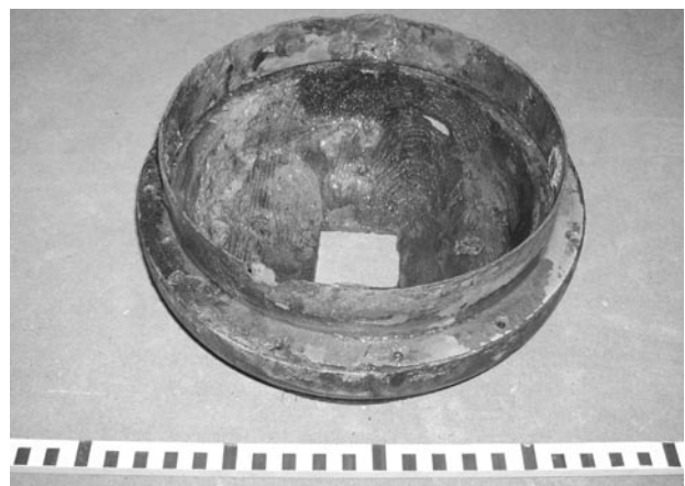
Abb. 3 Kompasshalterung, der untere Teil besteht aus Holz, der obere Aufhängung vermutlich aus Bronze (Foto: Florian Huber)
